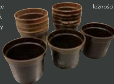
Biodegradowalne doniczki z biokompozytu HDPE-PE-g-MA-TPS
