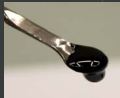
Produkt ciekły procesu upłynnienia węgla ze złoża Turów dla określonych parametrów procesu (340°C, p = 145 bar, czas reakcji = 15 min)
