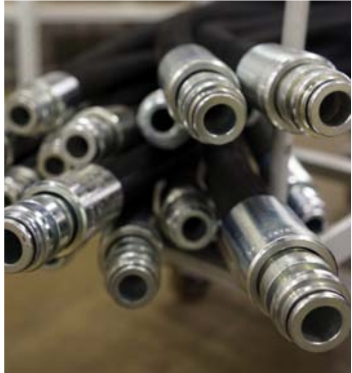
Park maszynowy doposażono w profesjonalne urządzenia oraz stanowisko do prób ciśnieniowych, które umożliwiają produkcję przewodów hydraulicznych. FOT.: Jan Czypionka
