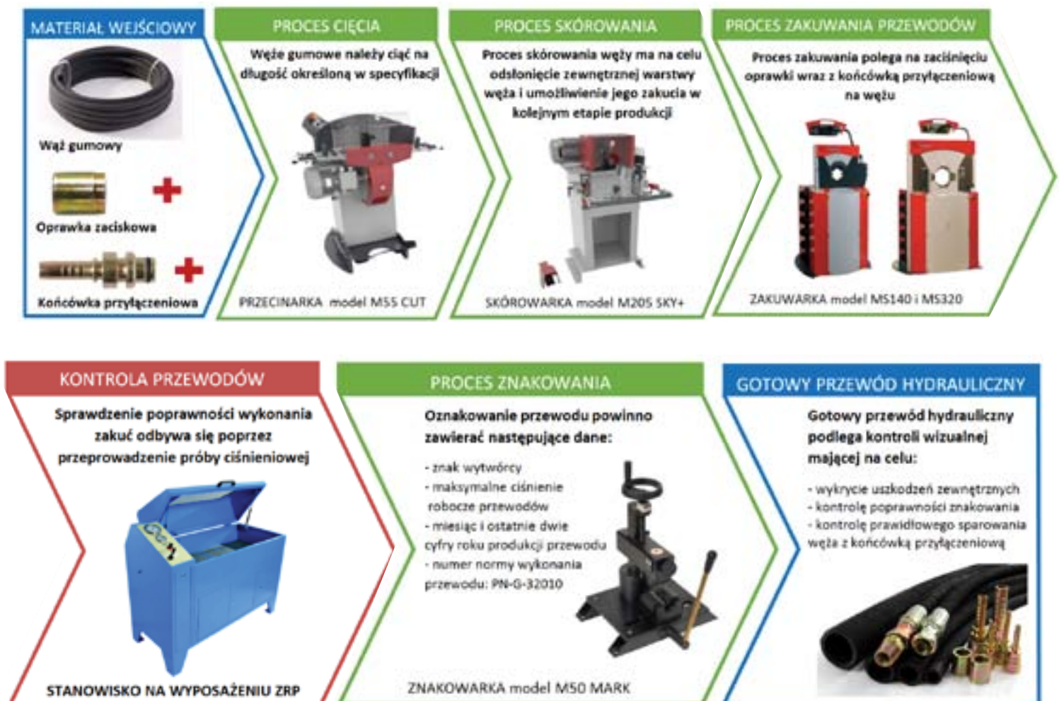
Schemat procesu produkcji przewodów hydraulicznych
