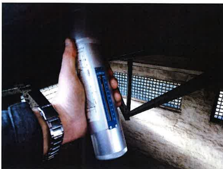
Fot. 1. Przebieg badania młotkiem Schmidta - badanie cegły.
