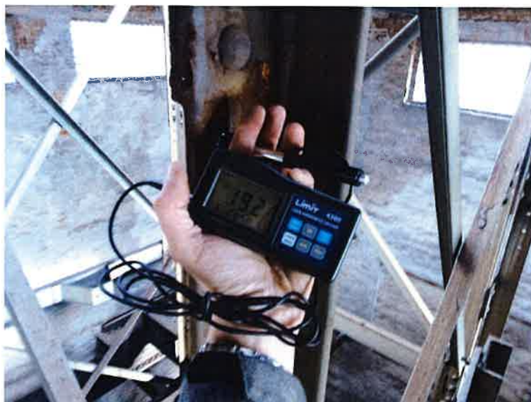
Fot. 1. Przebieg badania twardości stali.
