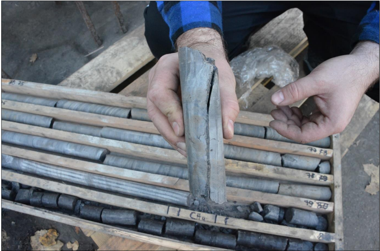
Rysunek 2.4 Podłużne spękanie łupka ilastego wtórnie wypełnione (źródło: materiały własne)
