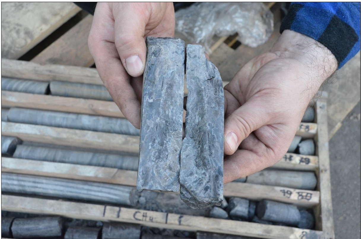
Rysunek 2.5 Podłużne spękanie łupka ilastego wtórnie wypełnione (źródło: materiały własne)
